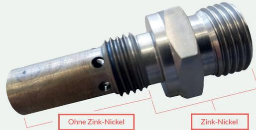
Vergleich von ZnNi und Zn Beschichtungen auf Wärmewiderstand unter Beibehaltung der Korrosionsleistung
