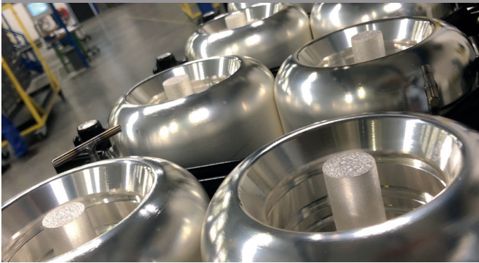
Verzilveren van inwendige diameters met binnenanode
